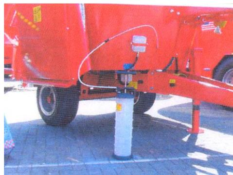
5. Выпустить вакуум через перепускной клапан вверху насоса и вновь установить воздухо-отводную трубку и вентиляционный ниппель на масляный бачок.
